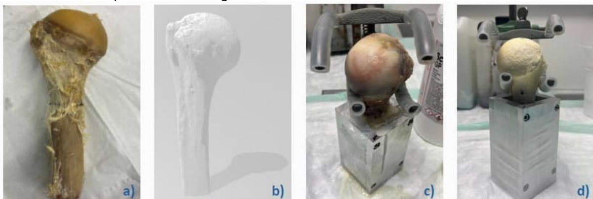
Abb. 1 a-d: Reinigung (a), Umwandlung CT- Daten in 3D-Datei (b), Einbettung der humanen (c) und künstlichen (d) Knochen
